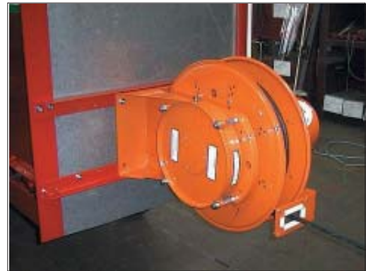
Trommelen festes vanligvis bak på riveren på eksisterende vinkeljern. Den kan også festes i vegg dersom man har rett kjørestrekning.
